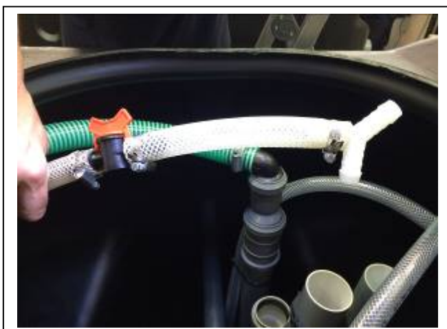
Fig. 15. Tercer depósito. Detalle de la Y de unión de las mangueras de los difusores 2 y 3.
